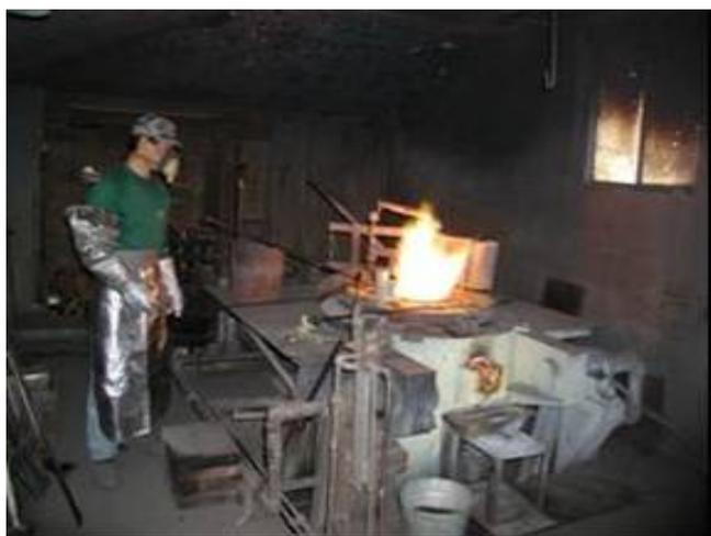
図1. 鉛合金を1200℃で溶解
