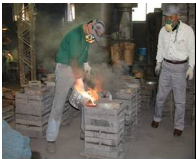
図2. 溶解した鉛を杓で鑄型に流し込む（湯入れ）
