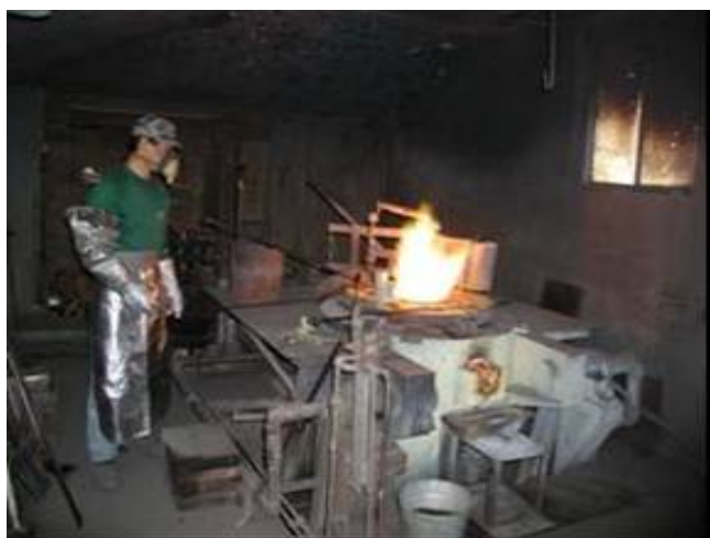
図1. 鉛合金を1200℃で溶解
