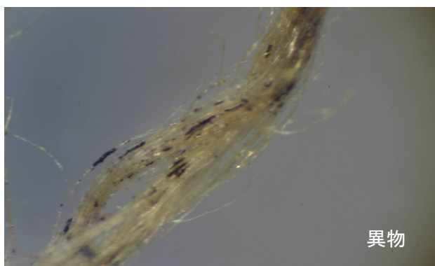
写真4 カヤステイン Q を用いて染色した異物および対照品の顕微鏡写真
