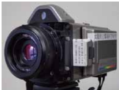
赤外線サーモグラフィーは、赤外線エネルギー量により面（画像）の温度分布を測定する装置
