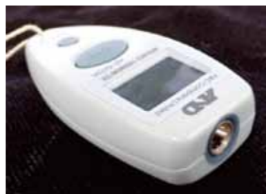
ボタンを押すと、狭い範囲の温度を文字として表示するハンディな放射温度計
