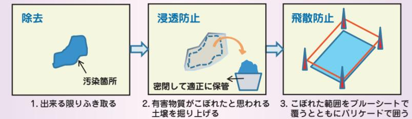
図 応急処置の一例（「土壌汚染の未然防止等マニュアル」より作成。）
