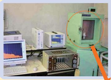
研究所では、ゲルマニウム半導体検出器付きガンマー線マルチチャンネルアナライザー(写真)という装置を使って放射能を測定しています。測りたい試料を測定容器の中に詰め、装置の中に置きます。装置は、自然界からの放射線をできるだけ遮断するため、分厚い鉛で覆われています。また、検出器は、マイナス196℃の液体窒素で常に冷やしておく必要があります。
