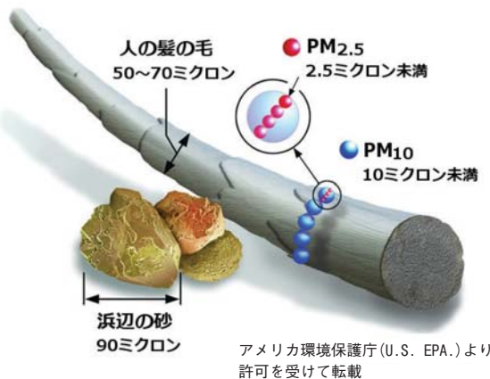
図2 微小粒子状物質 (PM 2.5 ) の大きさ 2.5ミクロンというのは、人間の髪の毛の太さの30分の1ほどの大きさです (1ミクロンは1000分の1ミリ)
