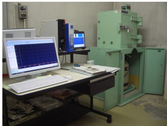
ゲルマニウム半導体検出器付γ線アナライザー 放射性核種の測定に用いています。
