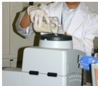
超遠心粉砕機による粉砕作業 含まれる物質を抽出しやすくするために、
