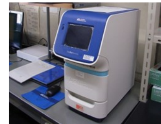
リアルタイムPCR機器 遺伝子の増幅をリアルタイムでモニターし解析する機器です。新型インフルエンザウイルスの他、多種の病
